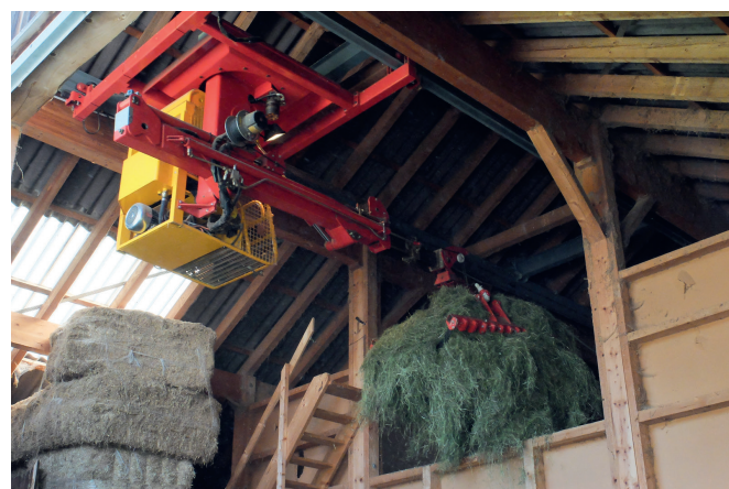
Futtereinlagerung und -auslagerung mit einem elektrisch betriebenen Heukran.
